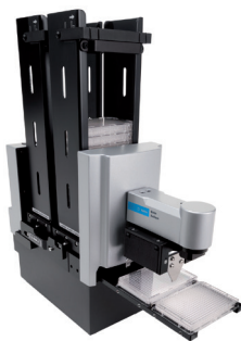
Figura 2. O empilhador de microplacas BioStack Agilent BioTek automatiza o processamento de múltiplas placas quando é estabelecida a interface com a 405 LS Agilent BioTek.
