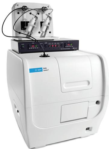
Cytation 7 com controlador de gás  $\text{CO}_2/\text{O}_2$  e injetor duplo de reagente.
