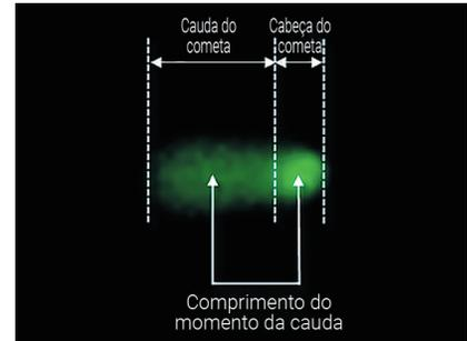
Os efeitos destrutivos de agentes mutagênicos, como a radiação de alta energia e produtos químicos, sobre o DNA nuclear são medidos com o ensaio cometa e os ensaios de imunofluorescência H2AX. O Cytation 7 é uma plataforma de captura de imagens ideal para esses ensaios.
