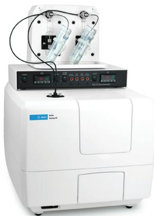
O Synergy H1 Agilent BioTek com controlador de gás CO<sub>2</sub>/O<sub>2</sub> e injetor duplo de reagente.
