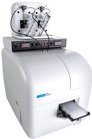
Leitor multimodal Synergy Neo2 com controlador de gás CO<sub>2</sub>/O<sub>2</sub> e injetor duplo de reagente.
